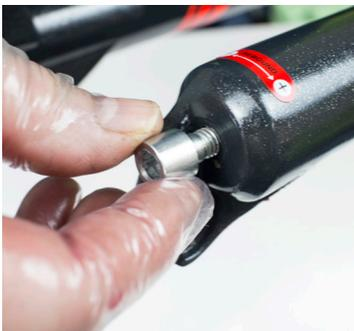
21. Die Gabel kopfüber und zusammengedrückt halten und die inneren Elemente wieder hineinschieben. Das Gewinde der Schrauben wird sichtbar. Die unteren Schrauben wieder festziehen und dabei aufpassen, dass auf jeder Seite die richtige Schraube genommen wird. 6 Nm.
