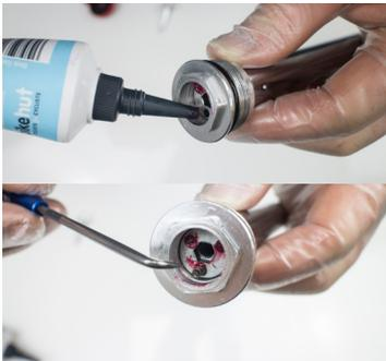
2. Ein wenig Schmieröl auf die drei Löcher in der Zugstufenregulierung auftragen.
