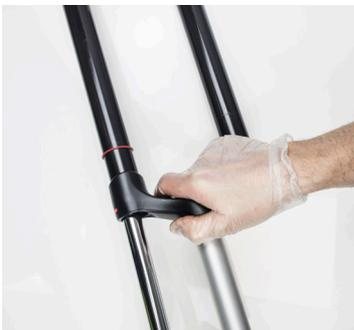
12. Die Ölpatrone aus dem Standrohr herausziehen.
