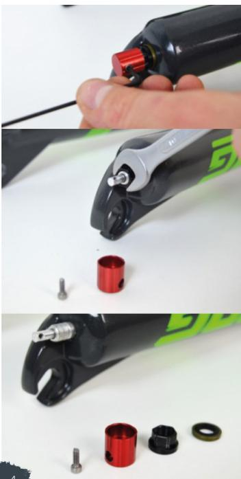
4. Nur für Frog 69/72: Den Zugstufen(Rebound)-Einstellknopf mit einem 2-mm-Inbusschlüssel entfernen. Dann mit einem 10-mm-Schraubenschlüssel die Schraube und den Spacer entfernen.
