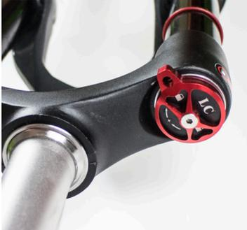
1. Den Druckstufenknopf an der Gabel in die Sperrposition (Lock-out) stellen und dann die Gabel vom Rahmen abmontieren.
