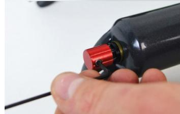
23. Die Zugstufenregulierung wieder zusammenbauen. Ein wenig Schmierfett auf das Zugstufengewinde auftragen. Spacer und Schraube wieder einsetzen. Den Knopf mit einem 2-mm-Inbusschlüssel festziehen.
