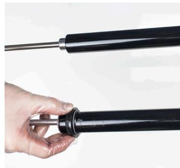
17. Neue Dichtungsringe und die getränkten Schaumringe auf die Standrohrbügel aufschieben und leicht einschmieren.
