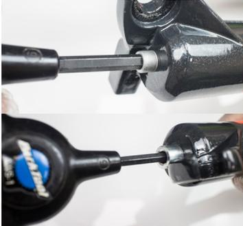
9. Die unteren Tauchrohrschrauben entfernen. 6 mm/5 mm.
