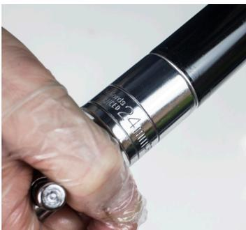
12. Im Standrohr wieder festschrauben. 18 Nm.
