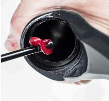
19. Die Tauchrohrbuchsen und Schwammringe mit einer Dübelstange einfetten.
