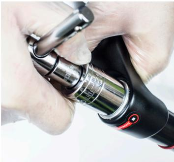
11. Die Metallkappe der Zugstufenregulierung je nach Version entweder mit einem 22-mm- oder mit einem 24-mm-Schlüssel abschrauben.
