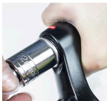
8. Mit einem 22-mm-Schlüssel festziehen. 18 Nm.
