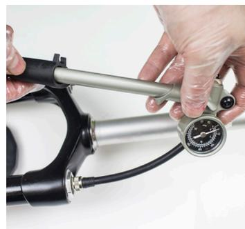
25. Mit einer Dämpferpumpe Luft in die Gabel pumpen, bis ungefähr 50 psi erreicht sind. (0271)
