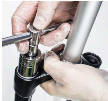
16. Die obere Luftventildichtungskappe aus Metall mit einem 24-mm-Schlüssel abschrauben.
