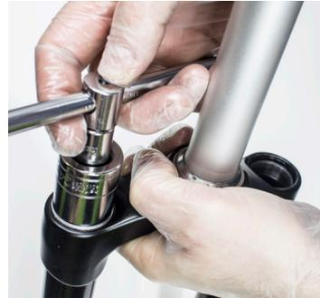
15. Die Luftventilkappe mit einem 24-mm-Schlüssel wieder anschrauben. 18 Nm.
