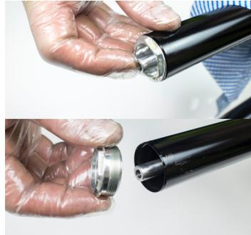
15. Die Luftkammer nach oben schieben und mit einem 24-mm-Schlüssel die untere Metallkappe entfernen. Dann die Luftventil-Kolbengruppe herauschieben.
