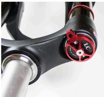
1. Mettre la fourche en position de blocage et la retirer du cadre.
