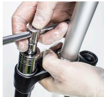
16. Dévisser le capuchon supérieur de la soupape d'air en alliage à l'aide d'une douille de 24 mm.
