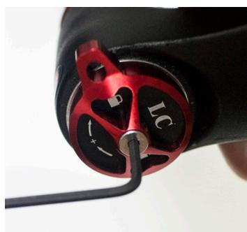
24. Remettre en place le levier de réglage de verrouillage rouge. La fourche doit être en position verrouillée et le capuchon dans la position appropriée.
