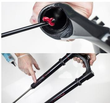
19. Graisser les fourreaux et les joints à l'aide d'une tige de cheville.
