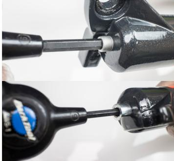
9. Desserrer les boulons inférieurs des fourreaux. 6mm/5mm.
