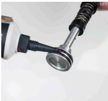
9. Graisser l'assemblage du piston de la soupape d'air.
