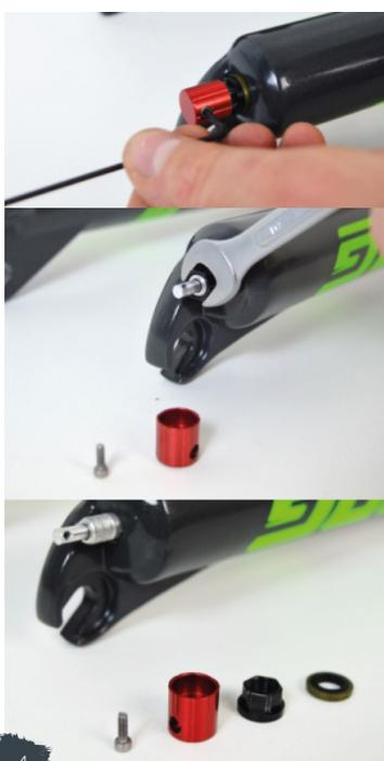
4. Frog 69/72 MTB uniquement. Retirez le bouton de contrôle du rebond à l'aide d'une clé Allen de 2 mm. Utilisez ensuite une clé de 10 mm pour retirer l'écrou et l'entretoise.
