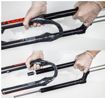
10. Séparer les plongeurs intérieurs et fourreaux extérieures en les faisant coulisser.
