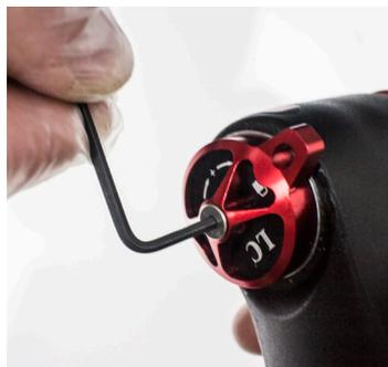
5. Retirer le levier rouge de réglage du verrouillage à l'aide d'un clé hexagonale de 2,5 mm ou d'un tournevis, selon la version.
