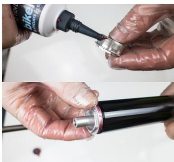
11. Graisser le filetage du capuchon d'air en alliage inférieur.
