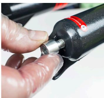
21. Avec la fourche à l'envers et comprimée, repositionner les tiges internes. Le filetage sera visible. Resserrer les boulons inférieurs en veillant à utiliser le bon boulon de chaque côté. 6Nm
