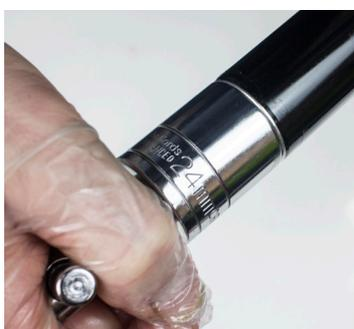
12. Resserrer les plongeurs. 18Nm
