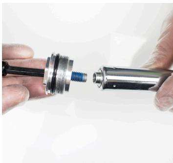
1. Fixer le capuchon supérieur de verrouillage en alliage à la cartouche d'huile à l'aide du boulon d'assemblage de verrouillage.
