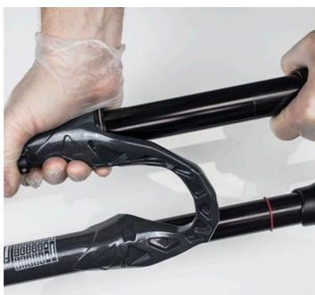
20. Remettre en place les plongeurs et les fourreaux en les faisant glisser.
