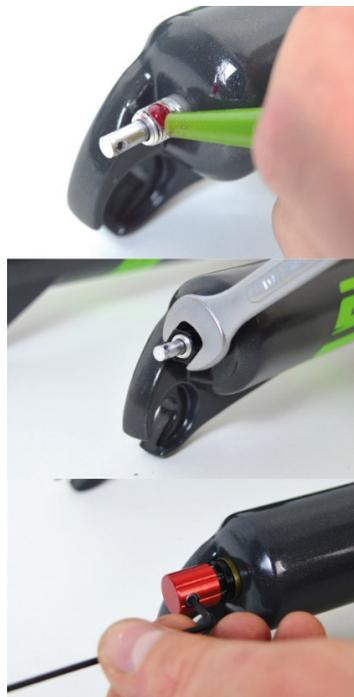
23. Remonter le régulateur de rebond. Appliquez une petite quantité de graisse sur le filetage de la pièce. Réinstallez l'entretoise et l'écrou à l'aide d'une clé de 10 mm. Installez le commutateur à l'aide d'une clé Allen de 2 mm.
