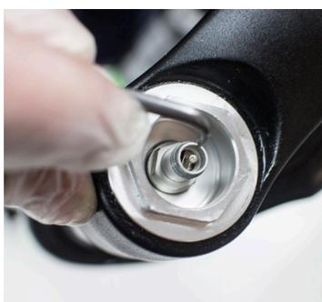
3. Dépressuriser la fourche à l'aide de la vanne d'air.
