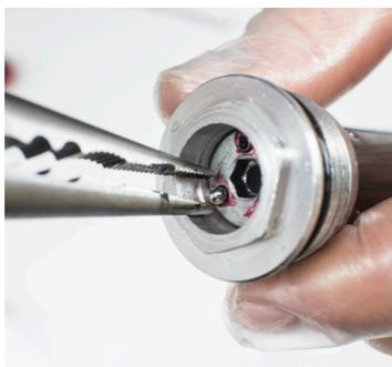
3. placer avec précaution les ressorts et les roulements à billes.
