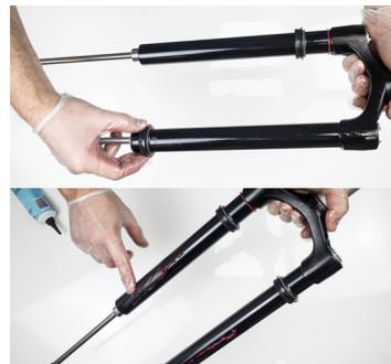
17. Neue Dichtungsringe und die getränkten Schaumringe auf die Standrohrbügel aufchieben und leicht einschmieren.
