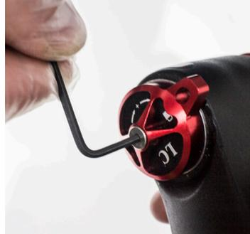
5. Den roten Druckstufenknopf entfernen.
