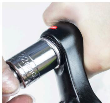
8. Mit einem 22-mm-Schlüssel festziehen. 18 Nm.
