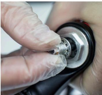
4. Die Zugstufenregelstange wieder in das Rohr einschieben.
