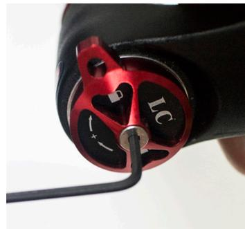
24. Den roten Zugstufen-drehknopf wieder anbringen. Die Gabel sollte sich in der verriegelten Position befinden und der Knopf in der entsprechenden Position.
