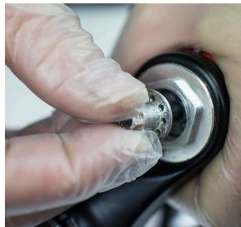
7. Den Zugstufenkolben herausziehen.
