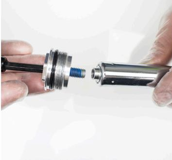
1. Die Metallkappe der Zugstufenregulierung mit der Zugstufenschraube wieder auf die Ölpatrone aufschrauben.
