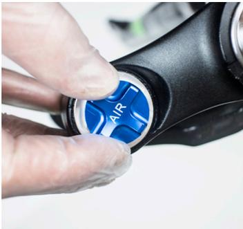
2. Die blaue Staubkappe des Luftventils entfernen.
