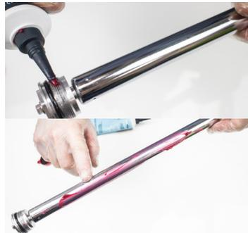
6. Das Gewinde der Zugstufenkappe und das Äußere der Ölpatrone leicht mit Öl schmieren.
