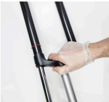
12. Die Ölpatrone aus dem Standrohr herausziehen.
