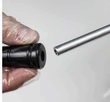
14. Den Gummidämpfer von der Luftkammer abziehen.
