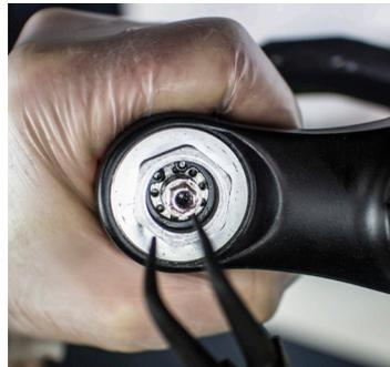
6. Den Sicherungsclip entfernen.
