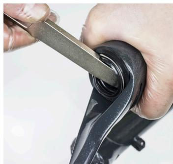
17. Die Dichtungslippen von den äußeren Bügeln entfernen. **Hinweis: Die Dichtungsringe mit einem großen Reifenheber entfernen. Bei der Remontage müssen neue Dichtungsringe eingebaut werden.**
