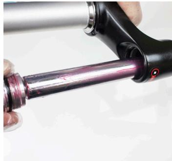
7. Die Patrone wieder in das Zugstufenstandrohr einschieben.
