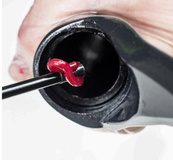
19. Die Tauchrohrbuchsen und Schwammringe mit einer Dibelstange einfetten.
