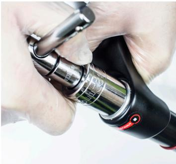
11. Die Metallkappe der Zugstufenregulierung mit einem 22-mm-Schlüssel abschrauben.
