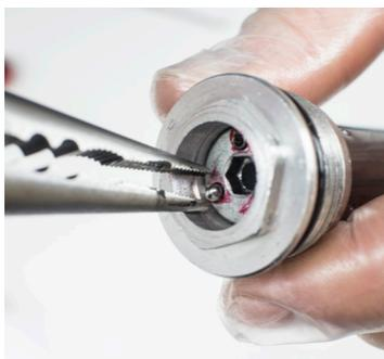
3. Replacer avec précaution les ressorts et les roulements à billes.
