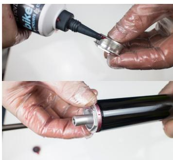
11. Graisser le filetage du capuchon d'air en alliage inférieur.
