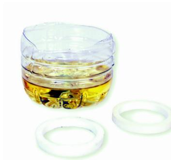
16. Tremper chaque anneau en mousse NEUF dans de l'huile de boîte de vitesses 80W jusqu'à saturation.
