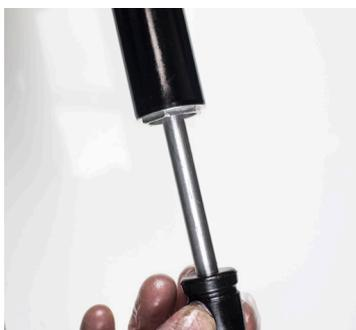
13. Retirer la tige d'air intérieure et mettre en place le tampon supérieur en caoutchouc.
