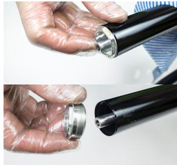
15. Faire glisser la tige d'air intérieure vers le haut et utiliser une douille de 24 mm pour défaire et retirer le capuchon d'air inférieur en alliage. Retirer ensuite le piston de la valve d'air.
