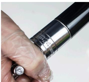
12. Resserrer les plongeurs. 18Nm
