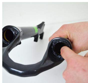
18. Appliquer de la graisse sur les anneaux en mousse.
