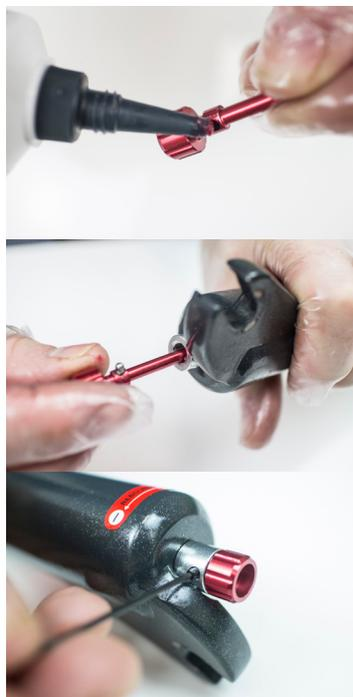
23. Remonter le régulateur de rebond. Appliquer une petite quantité de graisse pour maintenir le ressort et le roulement en place. Réinsérer dans le boulon et serrer la vis sans tête en place à l'aide d'une clé Allen de 1,5 mm.
