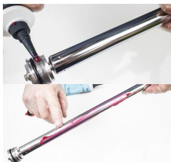
6. Graisser légèrement le filetage du capuchon supérieur du dispositif de verrouillage et la surface extérieure de la cartouche d'huile.
