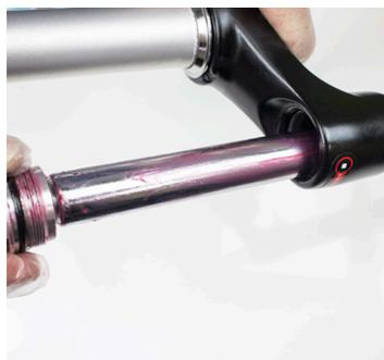
7. Replacer la cartouche dans le côté verrouillage des plongeurs.
