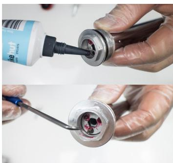
2. Ajoutez une petite quantité de graisse dans chacun des trois trous du boulon de l'assemblage de verrouillage.
