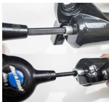
9. Desserrer les boulons inférieurs des fourreaux. 6mm/5mm.
