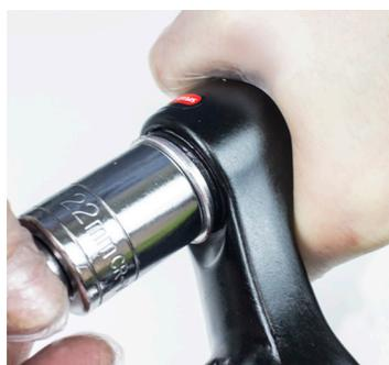
8. Serrer à l'aide d'une douille de 22 mm. 18Nm
