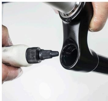
14. Ajouter environ 6ml d'huile de fourche 5W dans le plongeur côté Air.
