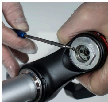
8. Retirer les 3 roulements à billes et les ressorts à l'aide d'un aimant.
