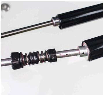
10. Replacer dans le plongeur par le bas.
