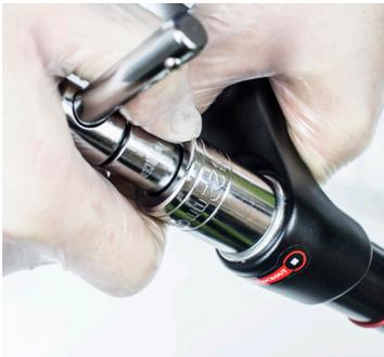
11. Dévisser le capuchon supérieur de verrouillage en alliage à l'aide d'une douille de 22 mm.
