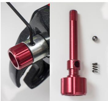
4. Frog 69/72 MTB uniquement. Retirez le bouton de contrôle du rebond à l'aide d'une clé Allen de 1,5 mm.
