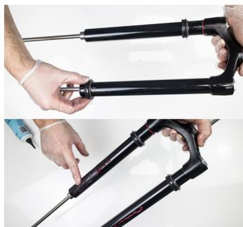
17. Glisser les NOUVEAUX joints racleurs et les anneaux en mousse imbibés sur les plongeurs et les graisser légèrement.
