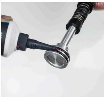
9. Graisser l'assemblage du piston de la soupape d'air.
