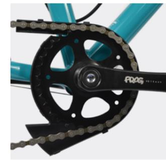
2. Installiere die Vorderplatte oben auf die Rückplatte. Jeder Clip muss mit einem hörbaren „Klick“ einrasten.
