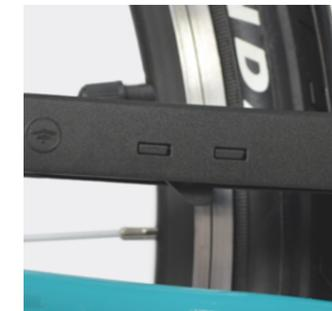
5. Überprüfe jeden Clip, um sicherzustellen, dass sie vollständig eingerastet sind und fest sitzen.
