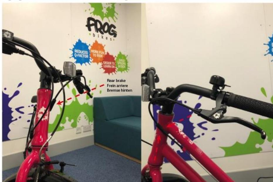
En ce qui concerne le standard de réglage des freins en Europe (le levier de frein droit est relié au frein arrière), le câble doit être acheminé le long du côté droit du tube de direction (voir image ci-dessous pour le réglage des freins en Europe).
