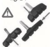
À propos de l'usure du patin : S'il existe une ligne d'usure, sur le patin du premier plan, le patin est utilisable jusqu'à ce que cette ligne soit atteinte. S'il n'y a pas de ligne d'usure, changez les patins si la profondeur des rainures de la surface de freinage est inférieure à 2 mm, comme sur les deux patins à l'arrière-plan.
