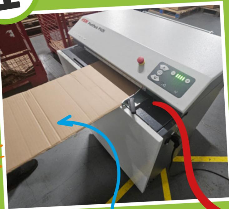
Kartonverpackungen, die wir von Lieferanten erhalten, werden in die Maschine eingeführt
